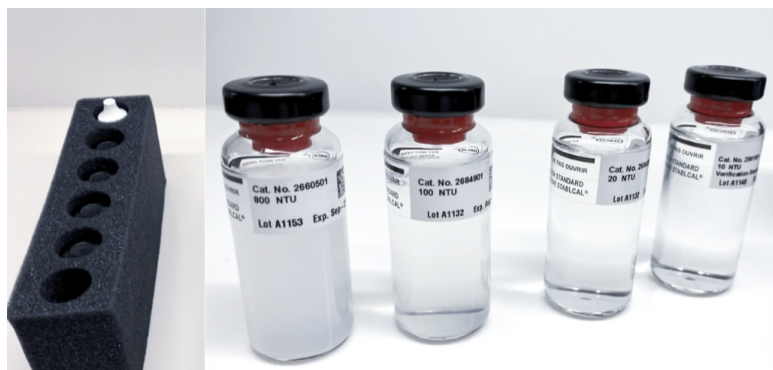
Figur 2 - Samples med kendte NTU-værdier. I den lille hvide flaske er der olie - se punkt 3 herover
